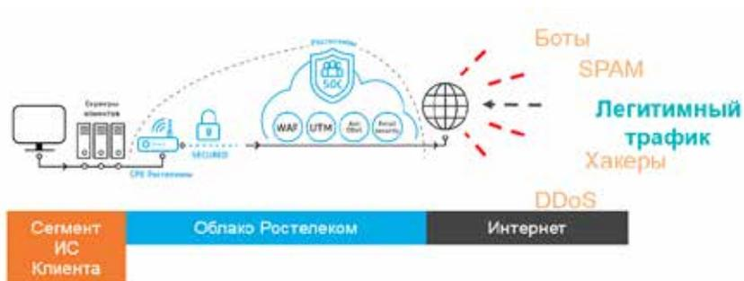
Рисунок 3. Схема подключения услуг по информационной безопасности.
