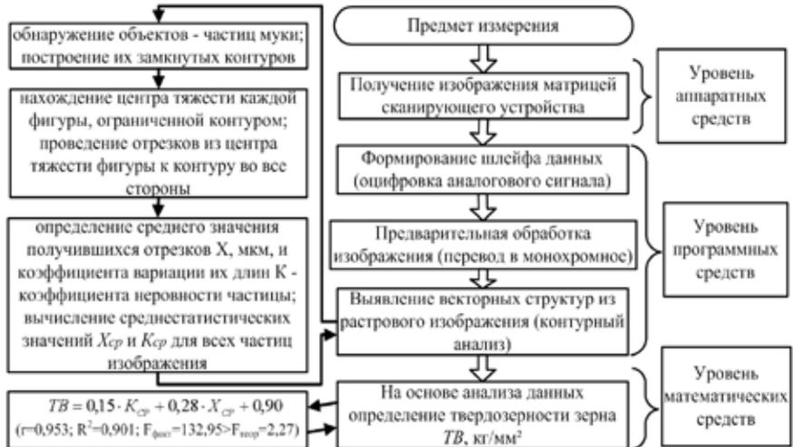
Рисунок 2 - Схема алгоритма обработки данных оптического микроскопирования
