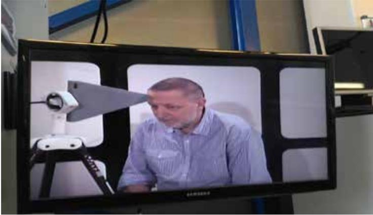
**Рисунок 4. Исследование в БЭК SAC-3 с использованием логопериодической антенны AC-4,30 с фирменным внешним МШУ AC010180-021. Фото с демонстрационного экрана.**
