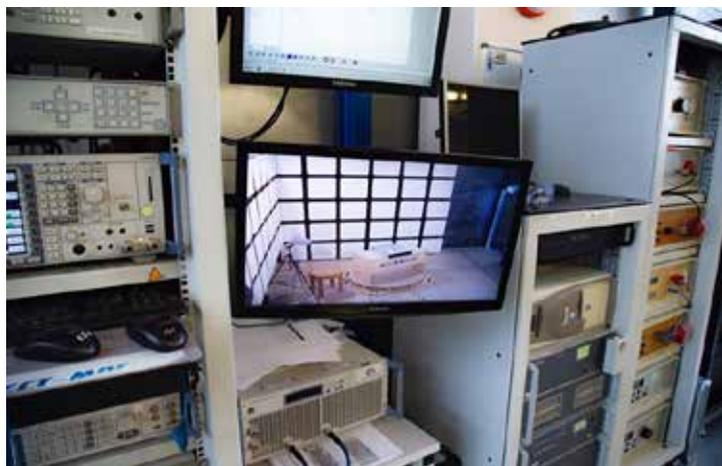
**Рисунок 3. Приборный отсек вне защищенного помещения**
