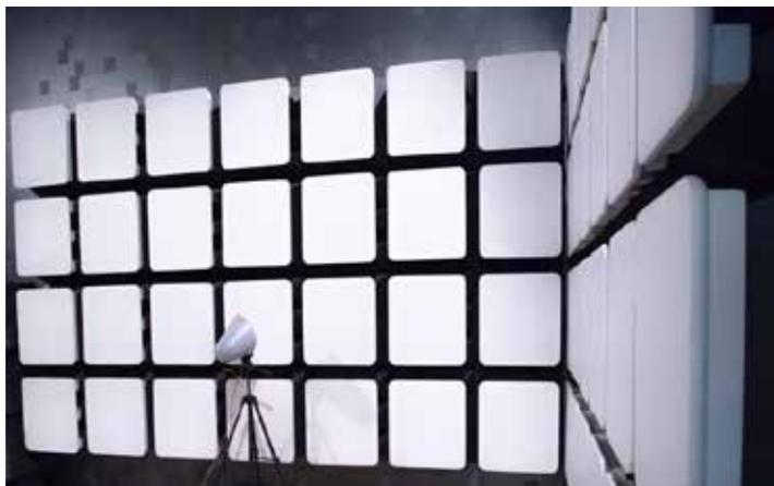
**Рисунок 2. Защищенное помещение полубезэховой экранированной камеры SAC-3 ФБУ «Ростест-Москва»**
