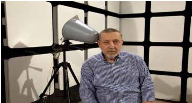
**Рисунок 5. Исследование в БЭК SAC-3 с использованием логопериодической антенны R&S HL050 с внешним МШУ собственной разработки**
