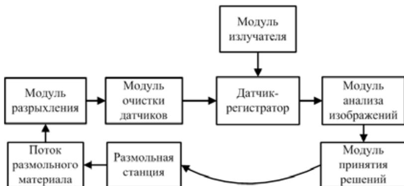
**Рисунок 1 - Схема мониторинга процесса переработки зерна**
