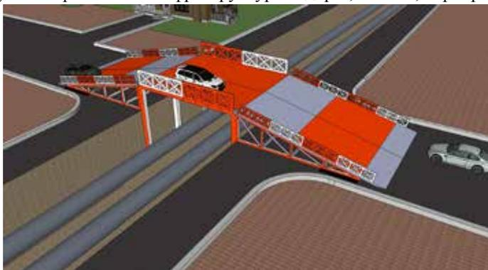
**Рисунок 2 – Модульный коммунальный путепровод**
