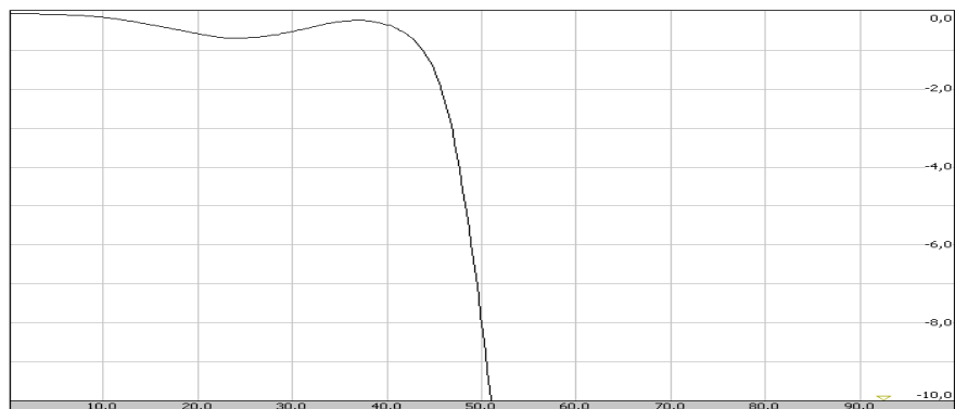
Рисунок 7 - АЧХ фильтра в полосе от 0,3 до 100 МГц
