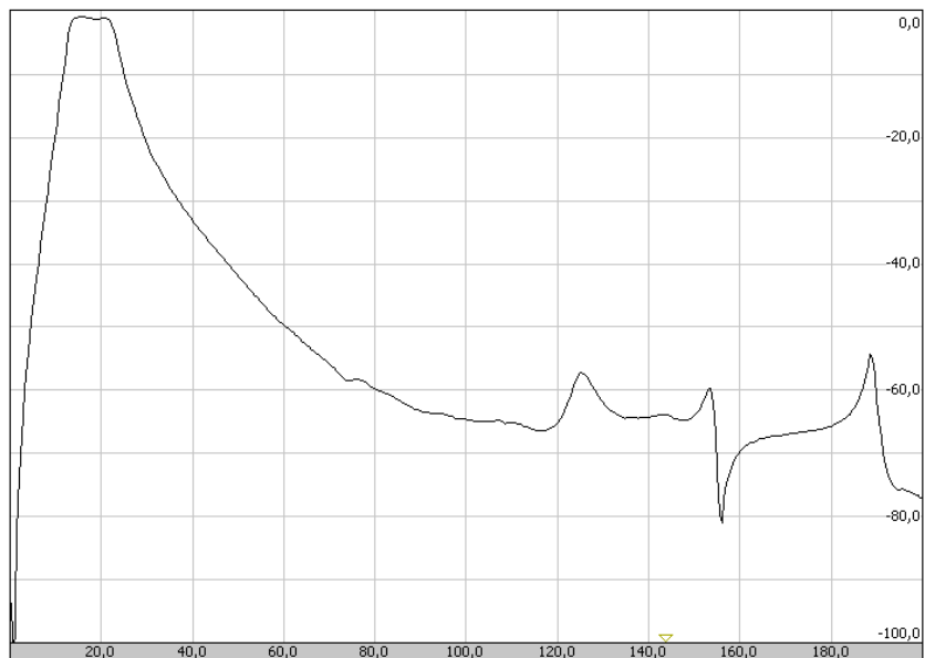
Рисунок 6 – АЧХ фильтра 14-20 МГц в полосе 200 МГц
