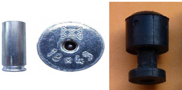
Рис.2. Патрон 18x45Т: вид сбоку и со стороны донца гильзы (слева) и резиновая пуля к нему со стальным сердечником (справа).
