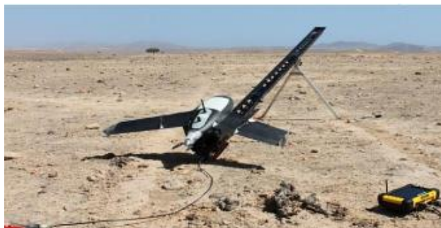
Рисунок 5.2 - Запуск БПЛА с катапульты
