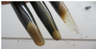
Рисунок 1 - Результаты центрифугирования нефти: 1-проба нефти Б; 2-проба нефти А, 3-проба нефти В [4].
