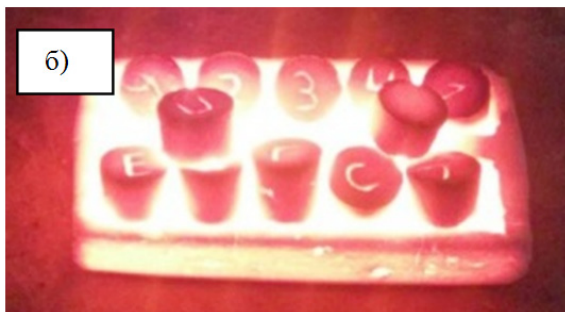
Рисунок 1 – Прессованные образцы-таблетки до обжига (а); полученные образцы клинкера после обжига (14500С) (б)
