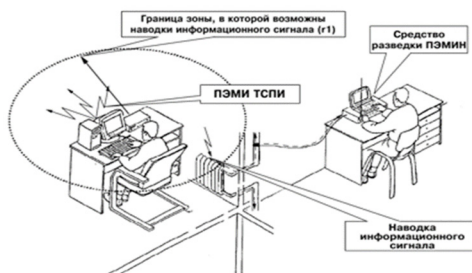
Рисунок 1 - Перехват наведенных ПЭМИ ТСПИ с посторонних проводников (инженерных коммуникаций).
