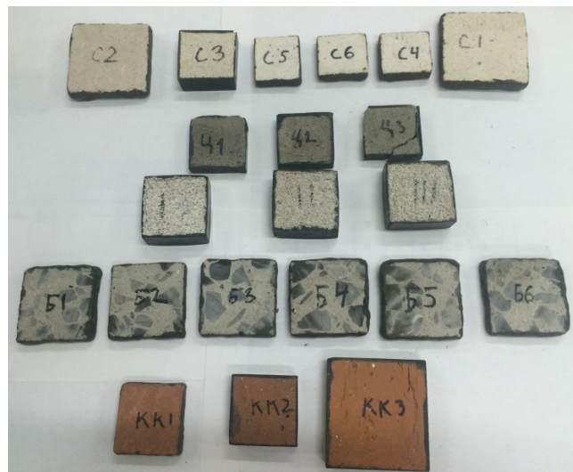
Рис. 1. Образцы пористых строительных материалов с гидроизолированными боковыми поверхностями
