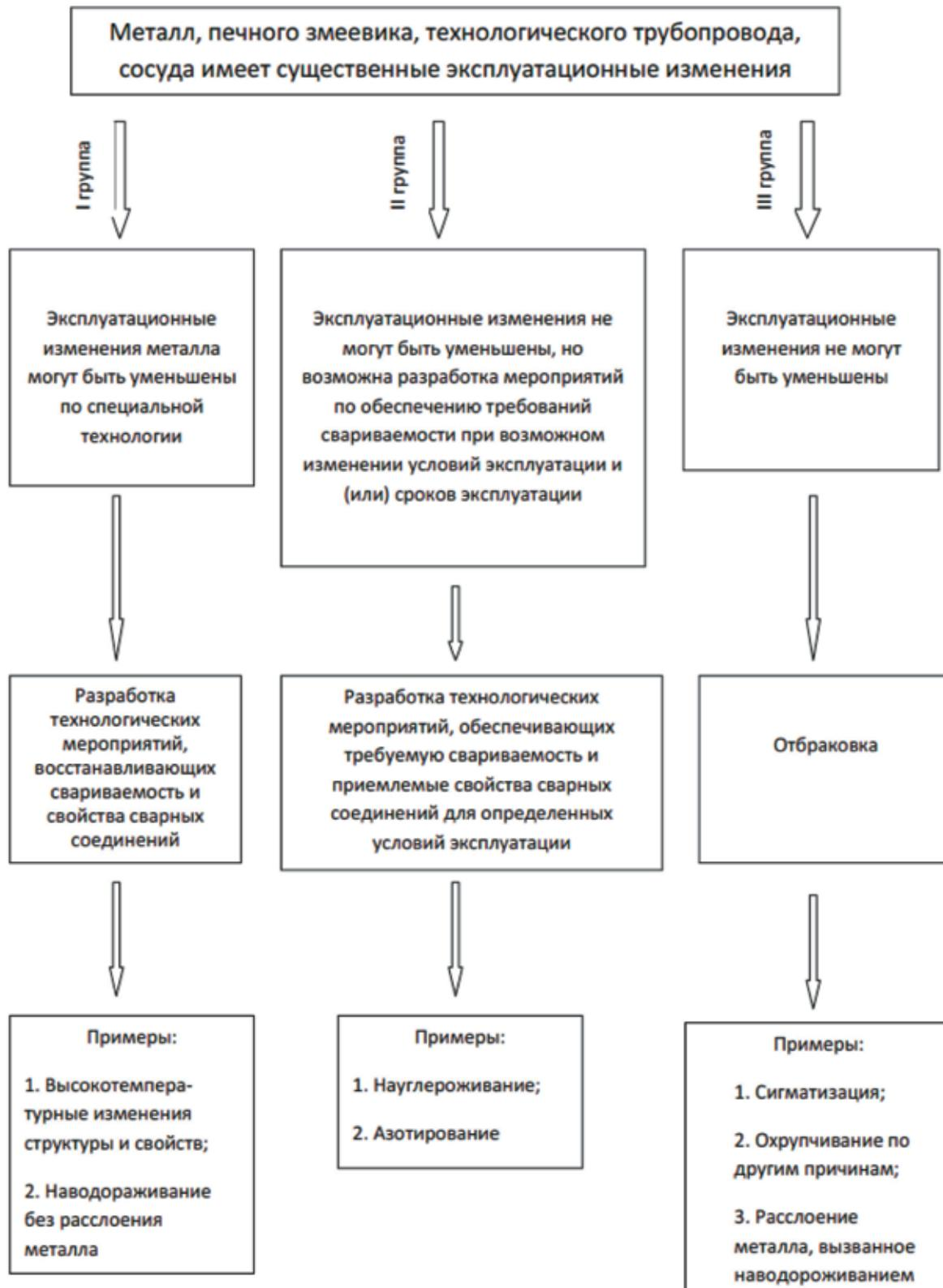
*Рис.1. Общий порядок обследования и допуска к дальнейшей эксплуатации производственных объектов по состоянию металла после сверхнормативной эксплуатации*
