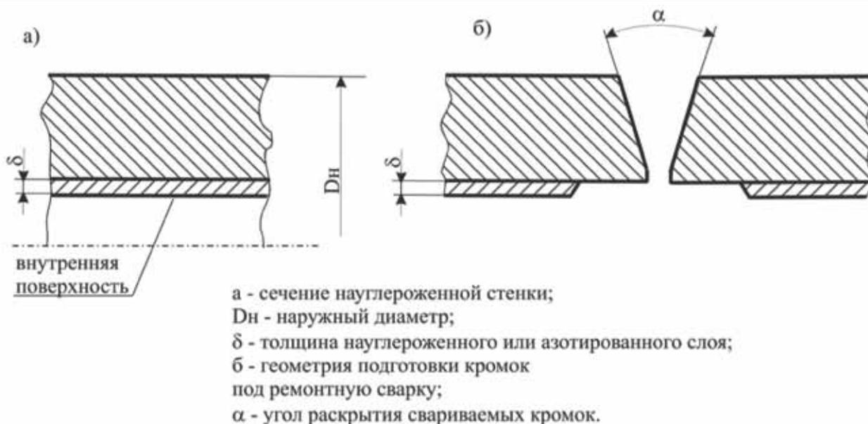
Рис.2. Характер науглероживания и азотирование трубопровода или корпуса аппарата
